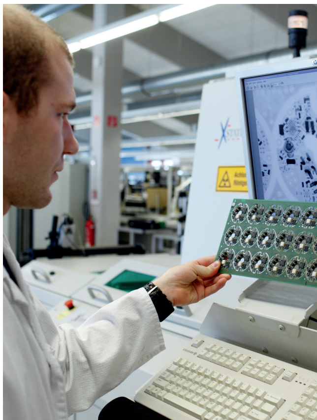
Рентгеновский контроль качества при производстве преобразователей температуры
